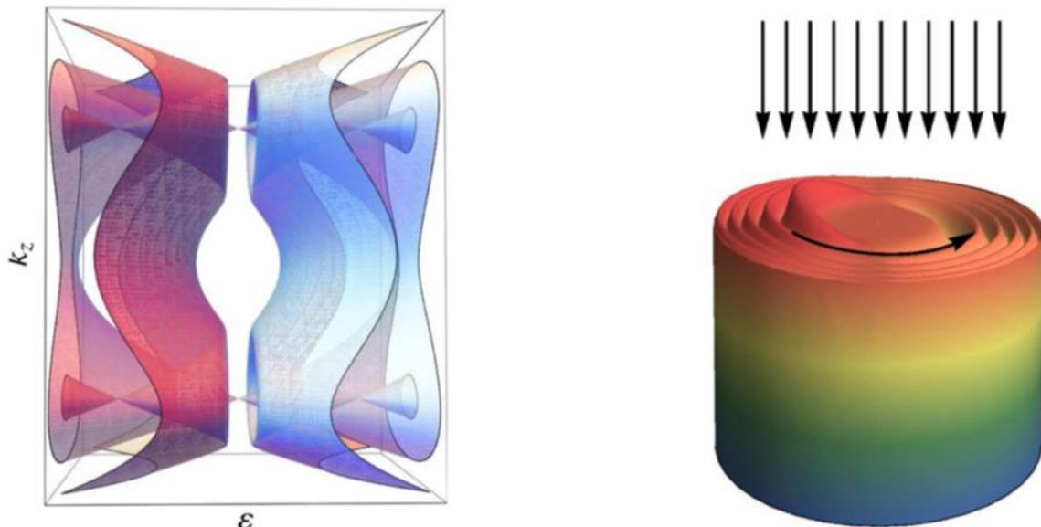
Esquema de la estructura de bandas del material y de la densidad electrónica en un cilindro del material. Las flechas muestran la radiación incidente y la dirección de rotación de los electrones. (CSIC)
