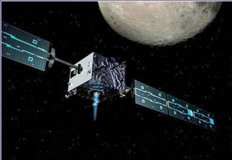
Se genera un plasma (Xe), los iones se aceleran en un campo eléctrico y se recombinan a la salida.
