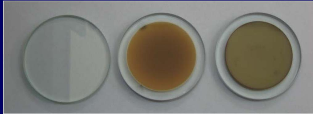
Ventanas de observación recubiertas paulatinamente con material metálico de las paredes del reactor
